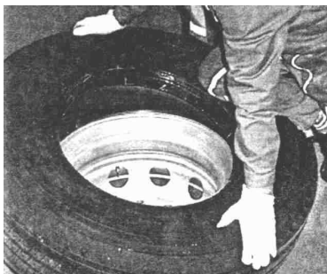
Montage du premier bourrelet
